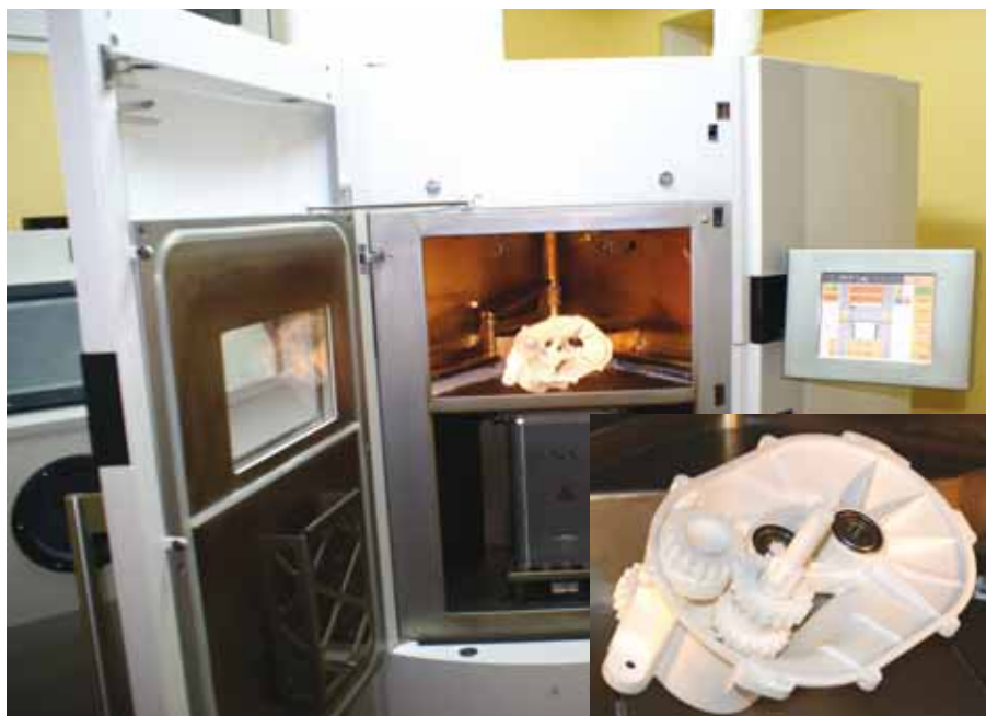
Uređaj za SLS Formiga P 100 (1-zatvoren, 2-kompleksna tvorevina načinjena u jednom koraku – prototip reduktora nove bušilice za zemlju)
