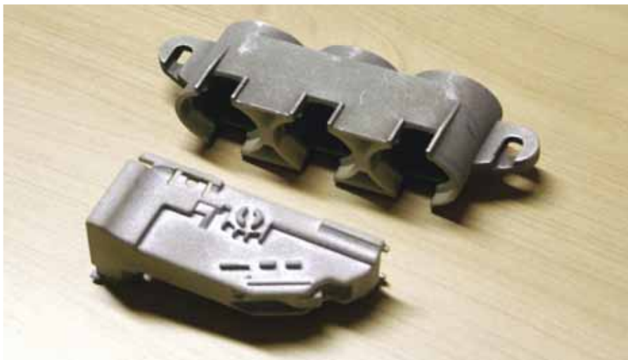
Prototipove načinjene SLS tehnologijom moguće je i metalizirati
